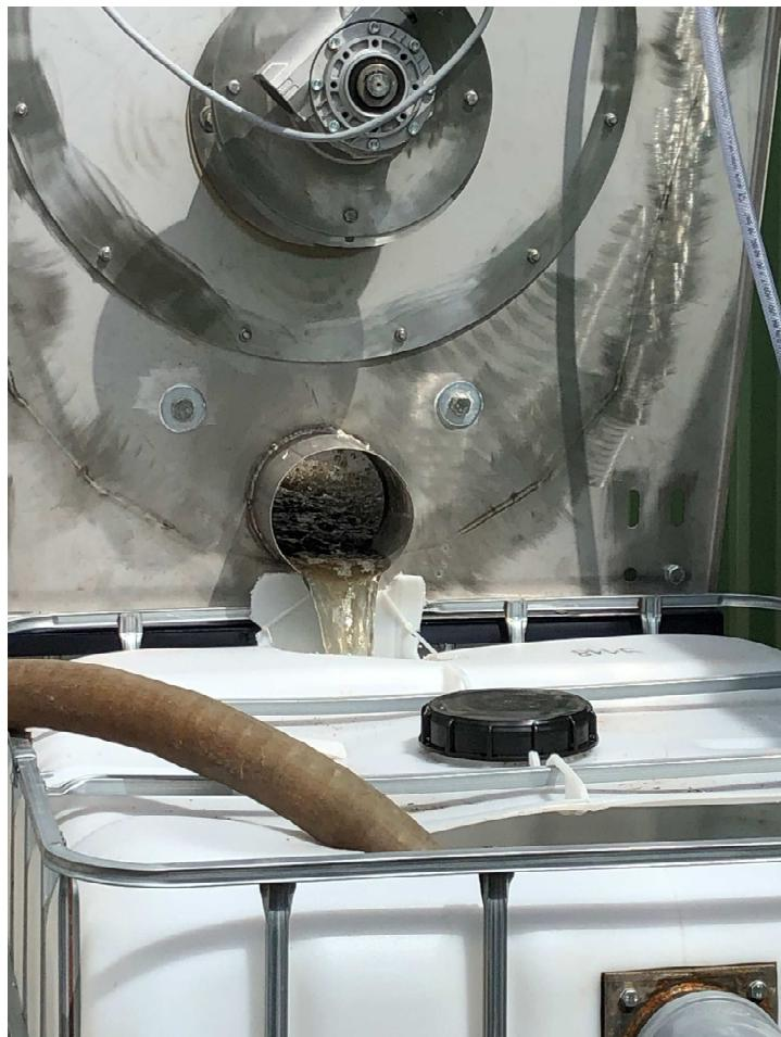
Erste Erkenntnis: PO<sub>4</sub>-P lässt sich optimal nach der ÜSS-Desintegration und vor der Faulung abtrennen
